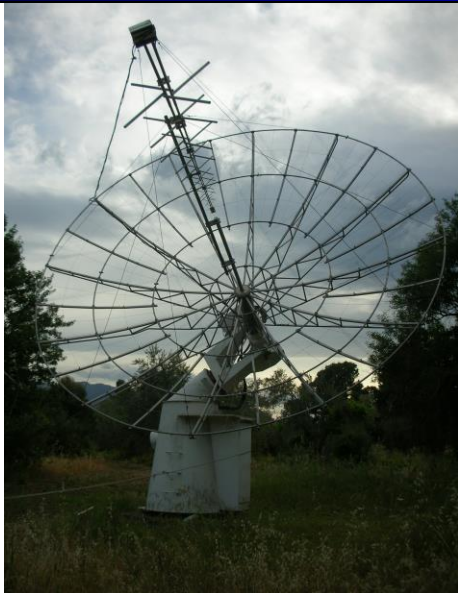
ARTEMIS IV πολυκαναλικός ηλιακός ραδιο-φασματογράφος στον δορυφορικό σταθμό Θερμοπυλών (20-650 MHz)
